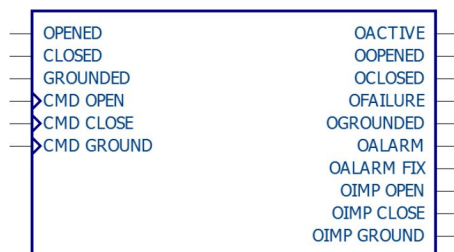
Rysunek 3.1. Blok funkcyjny A_DISCONNECTOR_EARTHING_01_02
